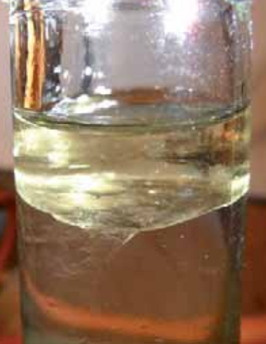
Das Ergebnis der Destillation, 3 ml ätherischen Öls auf einem Liter Hydrolat (Lavendel).
